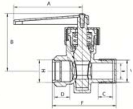
Cuerpo, vástago y bonete en bronce forjado de alta calidad. Grasa especial para gas; resistente al agua y no tiene punto de goteo
