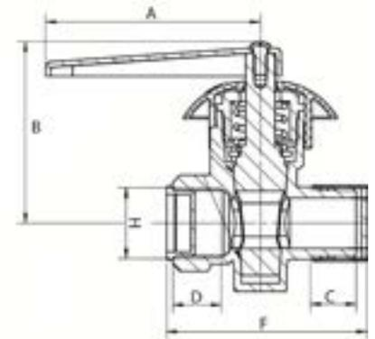
Cuerpo, vástago y bonete en bronce forjado de alta calidad. Grasa especial para gas; resistente al agua y no tiene punto de goteo
