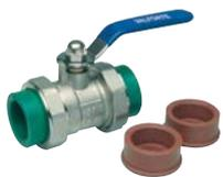
Cuerpo, bonete y bola de bronce. Asiento de bola de P.T.F.E. O-ring de NBR. Conector de terminal de PPR. Tuerca de fijación y vástago de bronce. Asiento de P.T.F.E. Arandela y tuerca de fijación de bronce. Manija de hierro.
